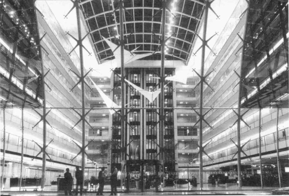
Las estructuras independientes de acero y luego las de hormigón armado generaron un cambio fundamental en las envolventes verticales de los edificios; que pasaron de ser sólidas y portantes, perforadas por ventanas para iluminación y ventilación a ser una membrana autoportante, ligera, multicapa y montada en seco, que separa el interior del exterior, controlando el pasaje de luz, aire, calor y sonido, tal como una PIEL.
