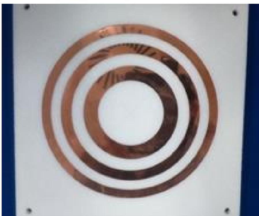
**Figura 6.25:** Antena lente de zonas de Fresnel Construida.
