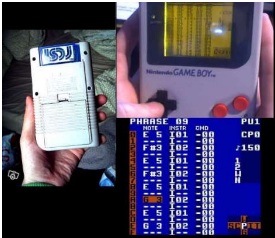
Figura 07: Tracker Little Sound Dj cartucho Tracker utilizado para componer música para consola portátil Game Boy.
