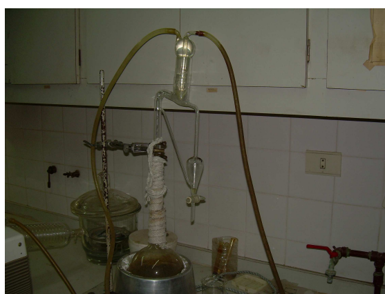
Figura 4. Equipo de destilación convencional de laboratorio.
