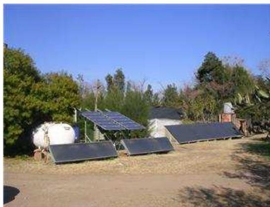
Figura 1: Fotografías de la cámara y de los colectores solares del dispositivo experimental instalados en INTA Catamarca.
