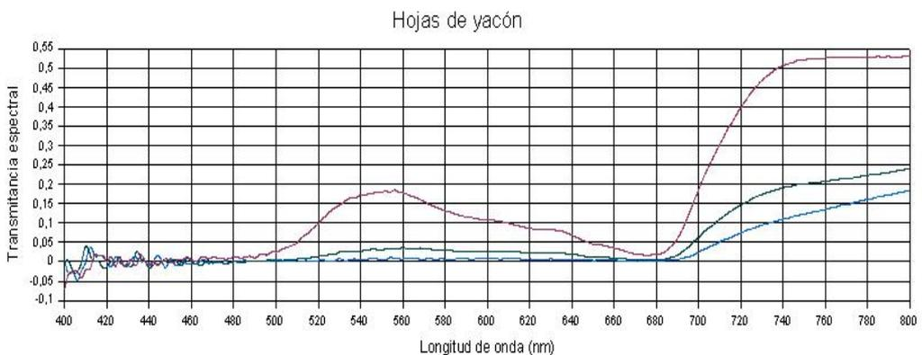
Figura 7: Transmitancia espectral de hojas de yacón en diferentes etapas del secado.
