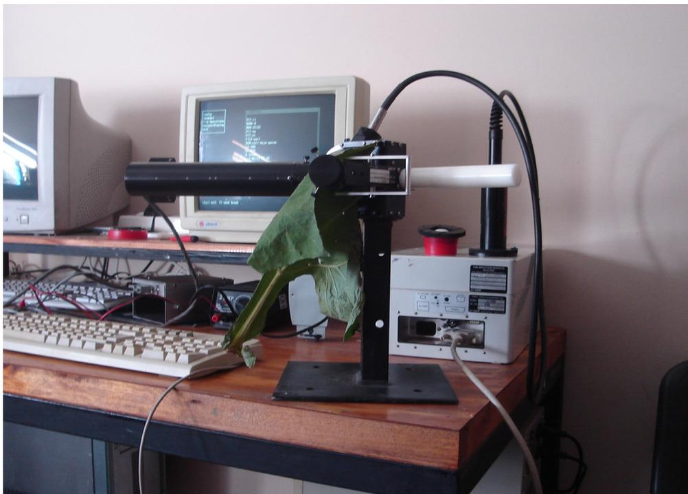
Figura 4: Equipo para la medida espectral de reflectancia y transmitancia.
