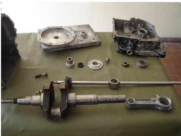
Fig. 9.- Muestra el estado actual del despiece del motor Stirling sin la camisa del pistón de desplazamiento
