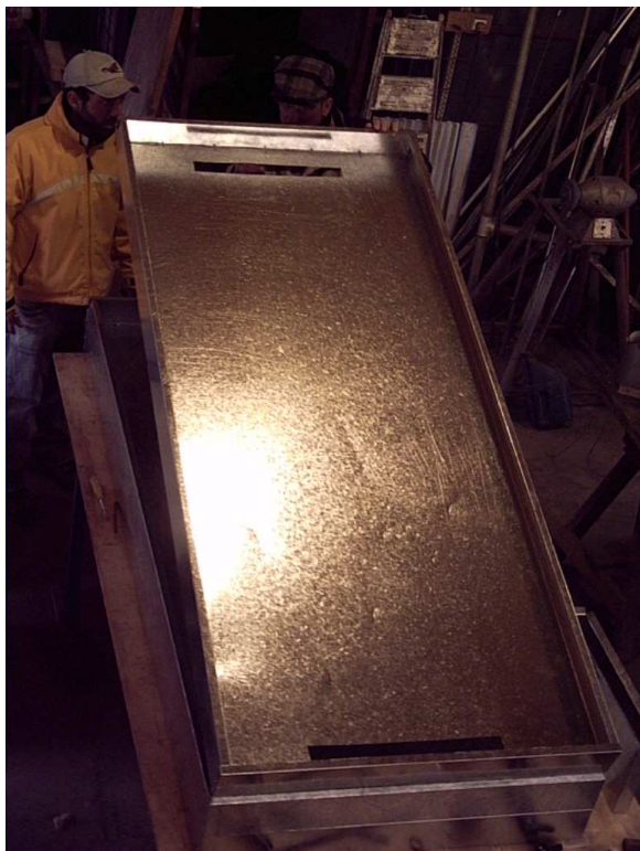
Figura 2: Caja del colector con las dos aberturas
