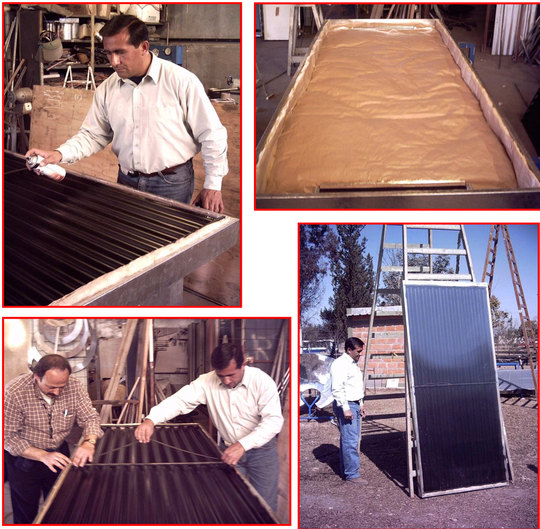
Figura 6: Distintas etapas durante el armado del primer prototipo
