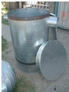
Figura 2.- foto de la unidad de Adsorción-Regeneración
