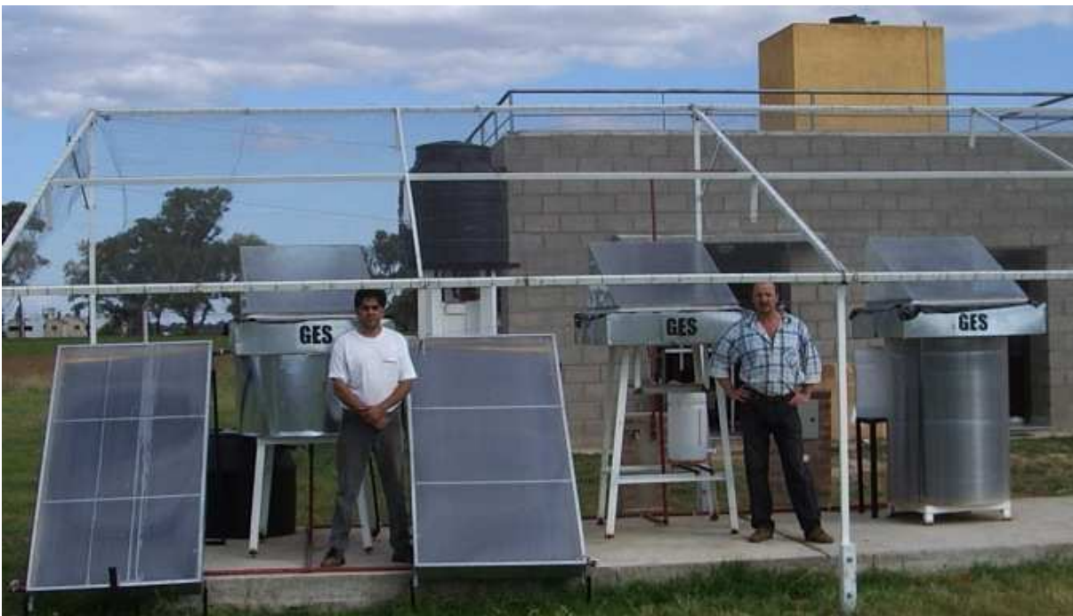
Figura 1. Vista de los destiladores solares en el laboratorio del G.E.S. de la Universidad de Rio Cuarto, antes de las reformas realizadas debajo del DB. De izquierda a derecha están el D2C., luego el DB y por último el DCSA.
