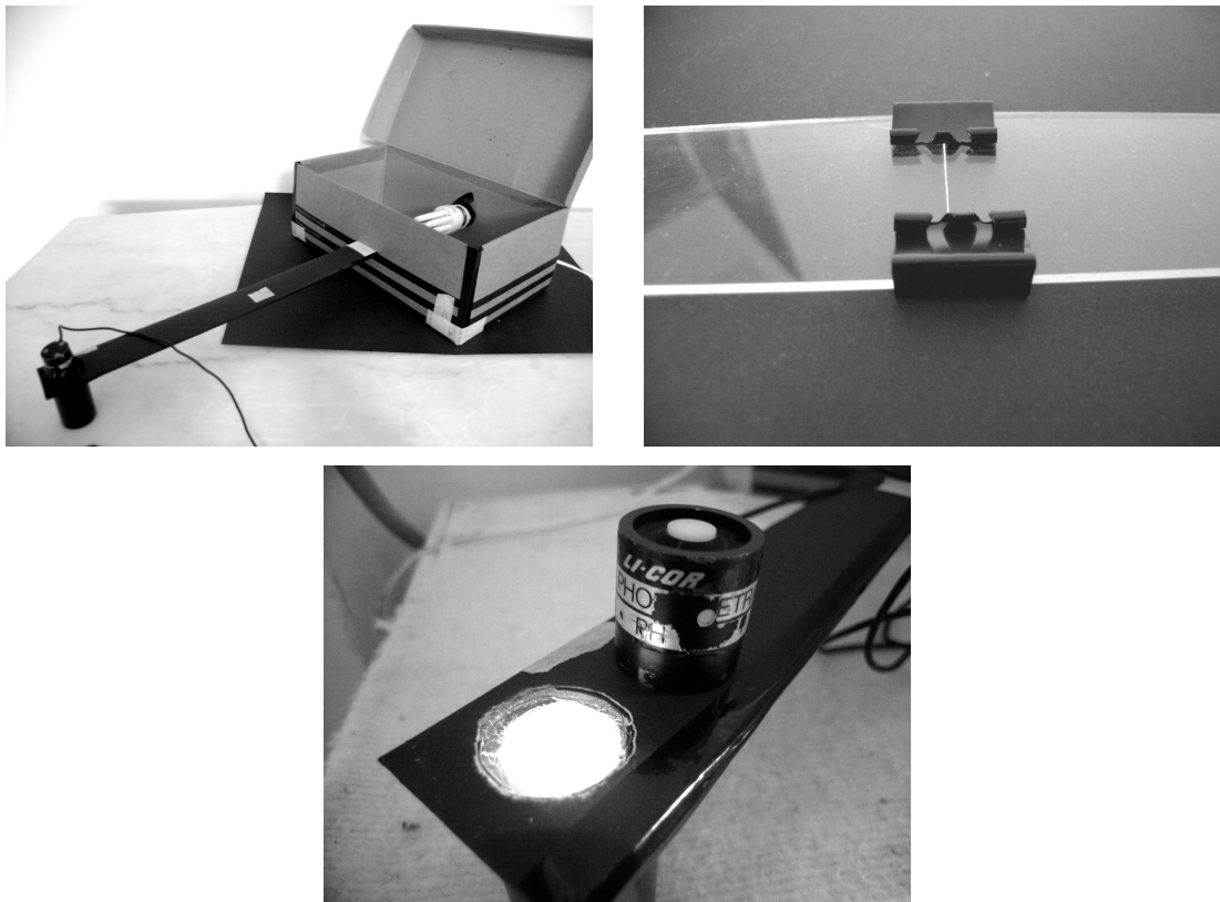
Imágenes: 1 - Vista general del experimento. 2 - Vinculación mecánica a tope. 3 - Área de salida de luz y sensor LI-COR.
