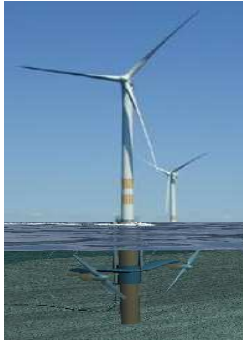
Fig. N°2: Turbina eólica con dos turbinas mareomotrices sumergidas en una misma columna soporte.
