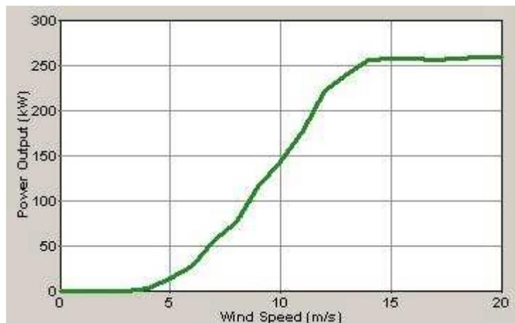
Figura 5: curva de potencia del aerogenerador WES 30/250.
