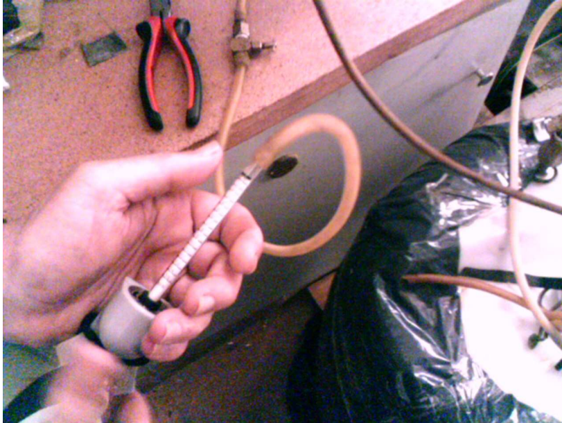
Foto N° 2: medición de H 2 S mediante bomba Dräger y ampolla reactiva
