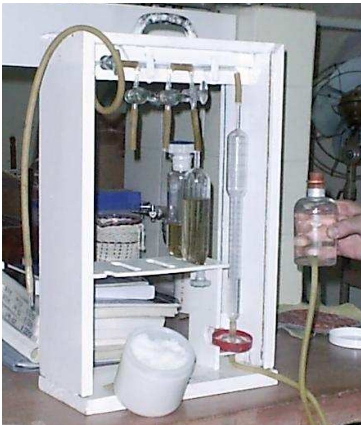
Foto N° 3: aparato de Orsat y reactivo utilizado
