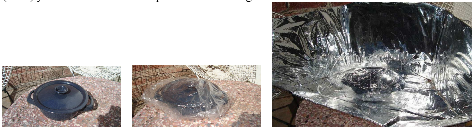
Figura 1: Olla oscura, cobertura de polipropileno y cocina solar pequeña.
