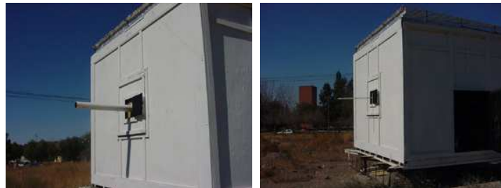
Figura 4. Vista exterior del dispositivo con los S.I.N., Ducto aluminizado y Barra acrílica respectivamente.
