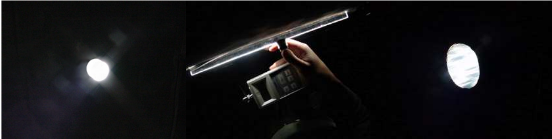
Figuras 6, 7 y 8: Aspecto del extremo emisor de cada uno de los tres sistemas de lumiductos evaluados: Barra acrílica, lamina acrílica y ducto respectivamente
