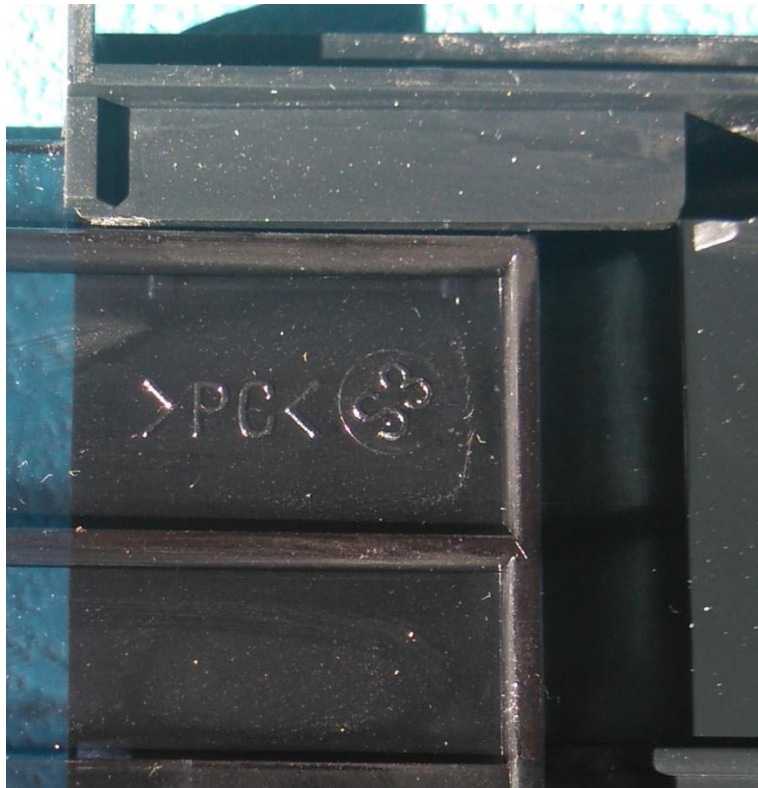
Ilustración 2: Identificación – Tipo de Plástico >PC<
