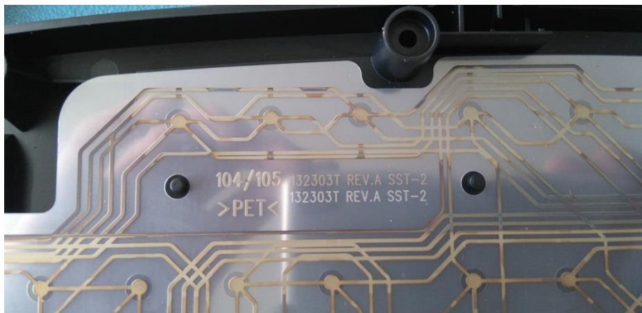
Ilustración 12: Membrana PCB hecha en PET
