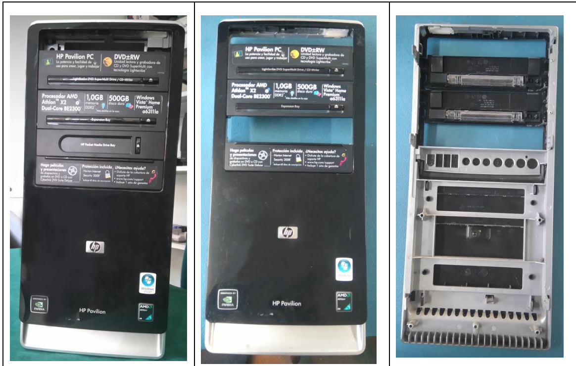
Ilustración 4, 5 y 6: Gabinete a desarmar, Panel Frontal (vista anterior y posterior)
