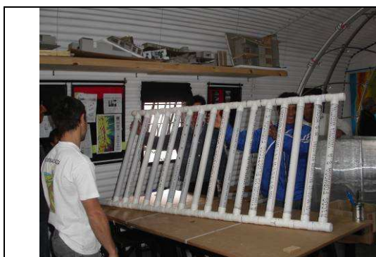
Figura 3. Construcción de la Parrilla de PVC
