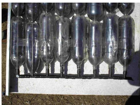
Figura 4 –Vista de la conexión de las botellas
