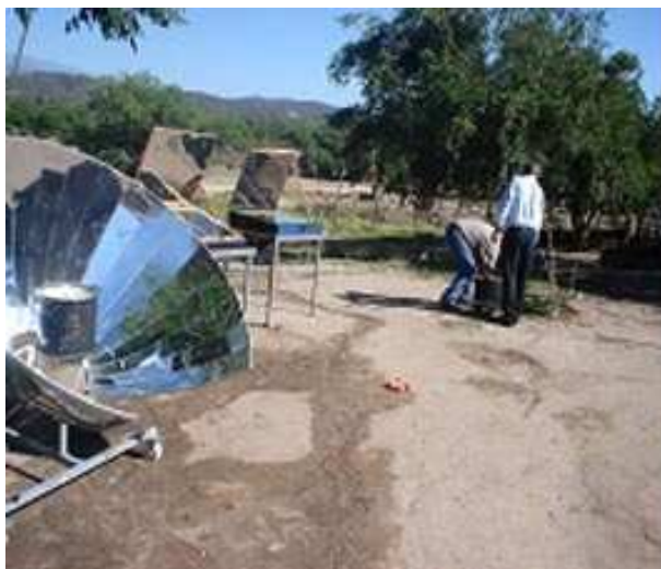
Fig.1 (a) Equipo solar para la cocción: a) concentrador con olla en su foco, b) cocinas tanques
