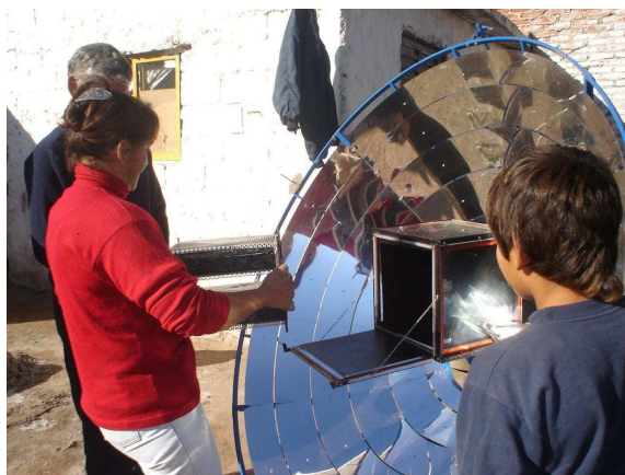
Fig. 1 (c) Equipo solar para la cocción: concentrador con horno en su foco
