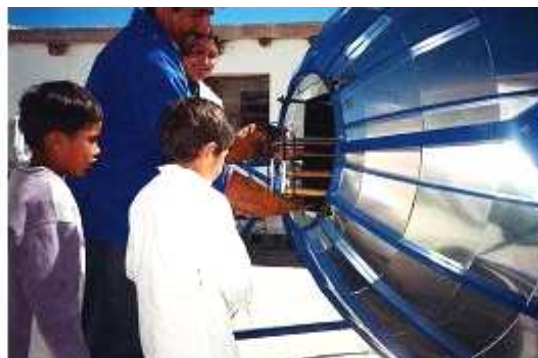
Figura 15. Cocción de pan en horno concentrador modificado
