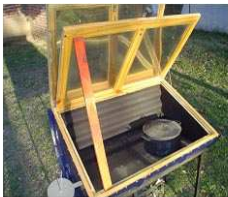
Figura 2. Cocina Tanque con olla en su interior.
