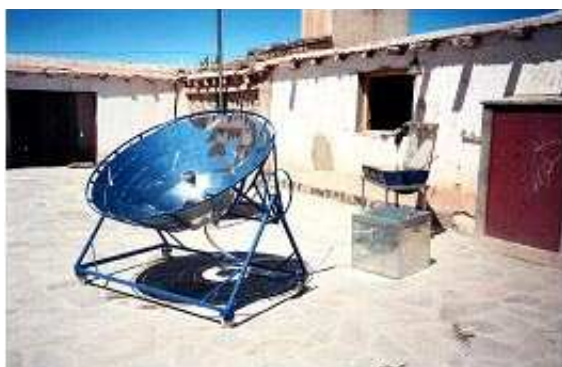
Figura 4. Cocina solar comunitaria con caja aislada
