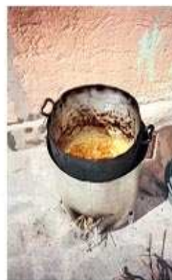
Figura 3. Brasero de alta eficiencia, con olla.
