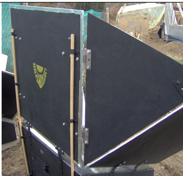
Figura 1b): Detalle de la sujeción de los reflectores, y puerta de acceso posterior.
