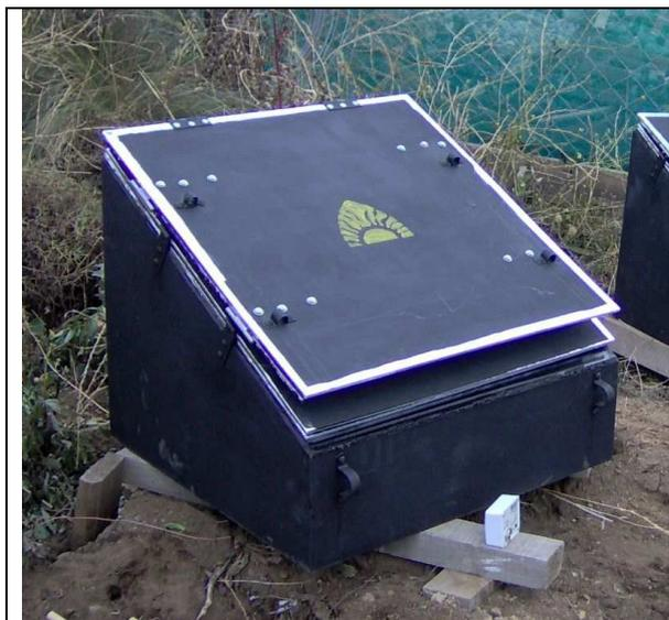
Figura 1a): Cocina solar con los reflectores cerrados. Se observan los soportes "U" inferiores para facilitar el acarreo.
