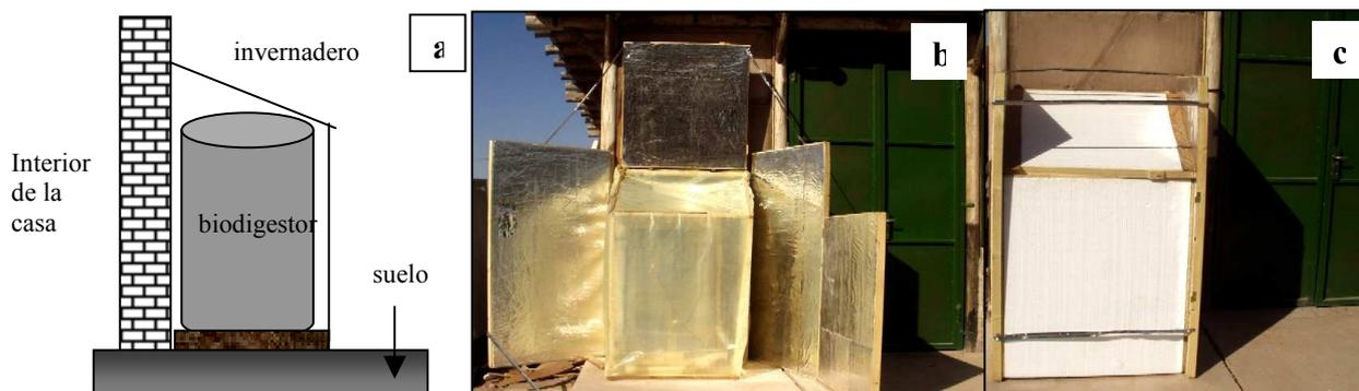
**Figura 4:** esquema de colocación del biodigestor con la cubierta del invernadero; b) invernadero abierto (posición día) c) invernadero cerrado (posición noche).
