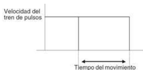
Figura 5: Relación de velocidad de tren de pulsos y tiempo de movimiento del modo Start-Stop .
