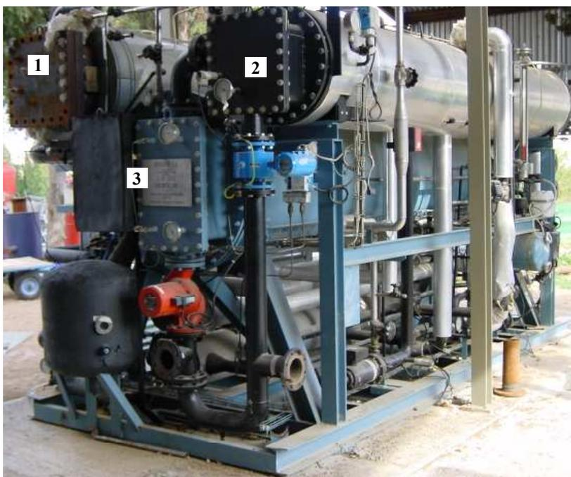
Figura 2 Fotografía del equipo en la que se aprecian los conjuntos de alta presión G2/C2 [1], media presión G1/C1 [2] y de baja presión E0/A0 [3]
