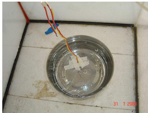
Figura 3. Recipiente con agua instalado en el modelo y termocuplas.
