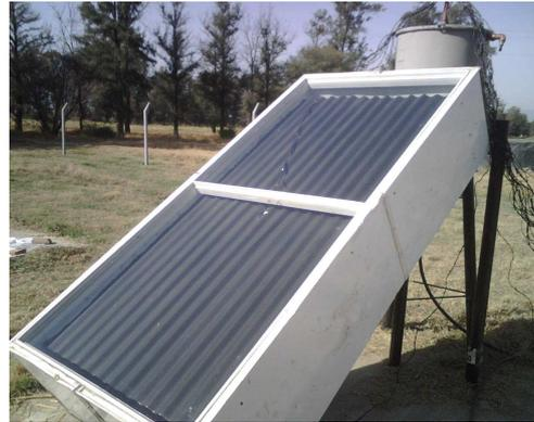
Fig. 2. Vista del calentador híbrido con una sola cubierta
