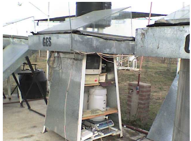
Figura 3. Vista del destilador solar de batea básico (D2)
