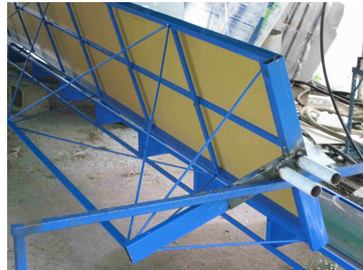
Fig. 4.- Muestra aspectos constructivos de los espejos..
