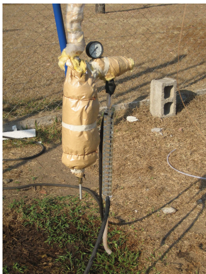
Fig. 7.-Muestra el separador de vapor junto con el condensador de vapor
