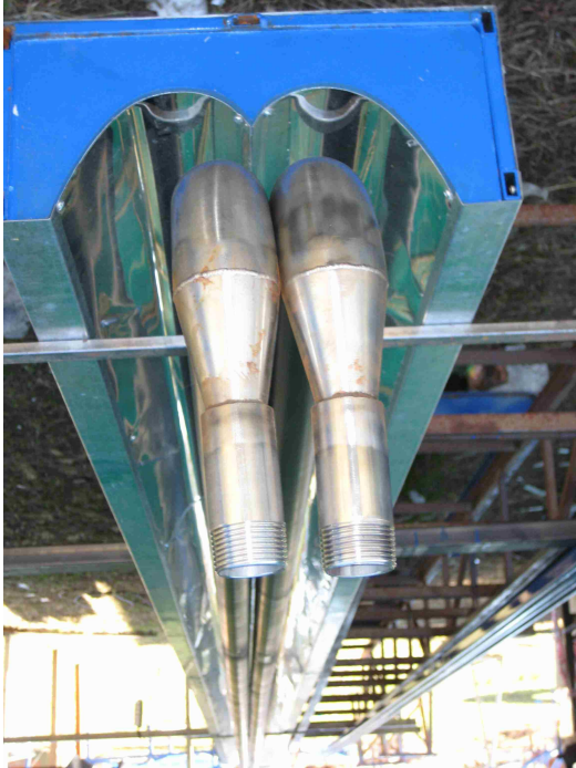
Fig. 3.- Muestra el espejo secundario y el absorbedor, que aún no está colocado en su posición final.
