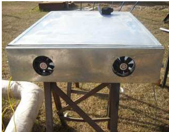
Figura 6: Vista de los ventiladores eléctricos.
