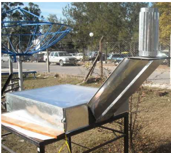
Figura 5: Vista lateral del secador con chimenea CPC.
