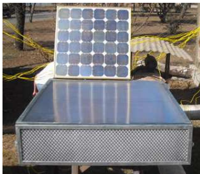
Figura 4: Secador con ventiladores eléctricos y panel fotovoltaico.
