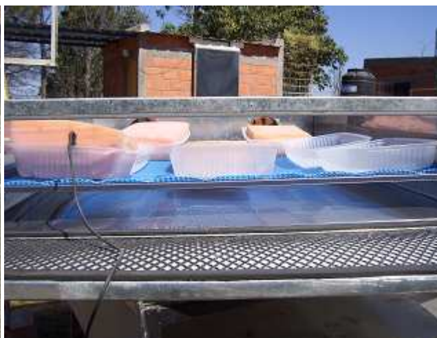
Figura 7: Vista de las bandejas con agua y esponjas en el secador Figura 8: Detalle de las bandejas con agua y de las esponjas.
