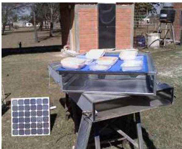
Figura 7: Vista de las bandejas con agua y esponjas en el secador Figura 8: Detalle de las bandejas con agua y de las esponjas.
