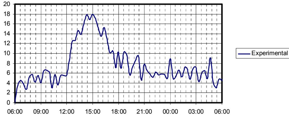
Figura 4: Curva experimental de producción del destilador DCSA
