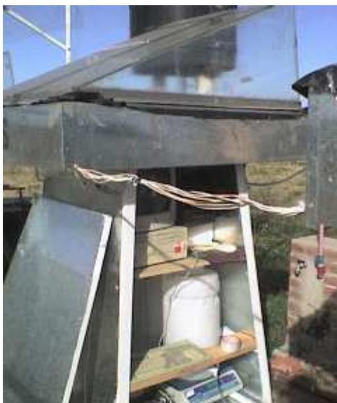
Figura 1: Destilador tipo DB, mostrando la instalación del sistema de adquisición de datos
