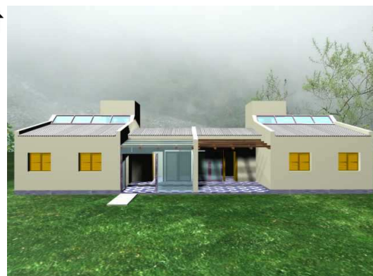
Figura 15: Frente de la vivienda con la situación invierno (galería protegida) y verano (pérgola)
