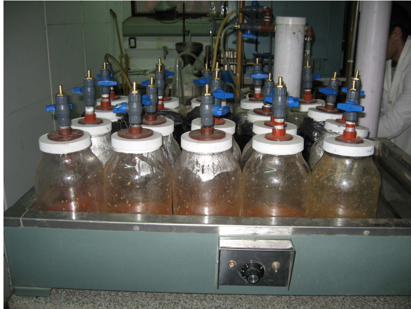
Imagen 2: Disposición de reactores en baño termostático.
