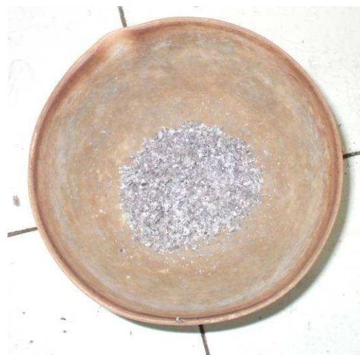
Imagen 1. Muestra de cenizas utilizadas para determinar Sólidos Secos y Sólidos Volátiles.
