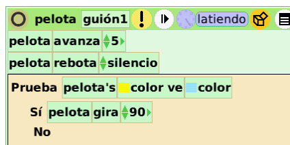
Fig. 10. Estructura condicional (mosaico “Prueba”) para detectar las colisiones entre la pelota y la paleta
