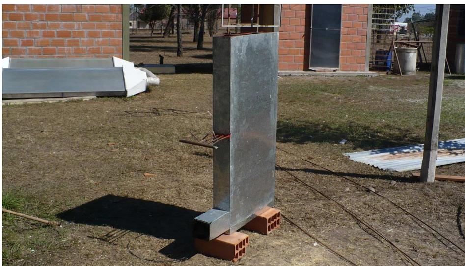
Figura 7: foto del prototipo para ensayos de enfriamiento evaporativo indirecto
