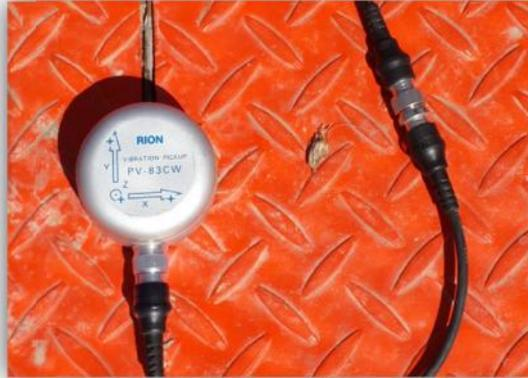
Fig. 11: Acelerómetro triaxial.
