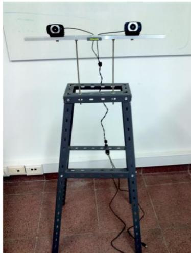
**Fig. 1.** Vista frontal de las cámaras sobre la montura de calibración. Las cámaras se encuentran a 150 mm del centro del sistema.
