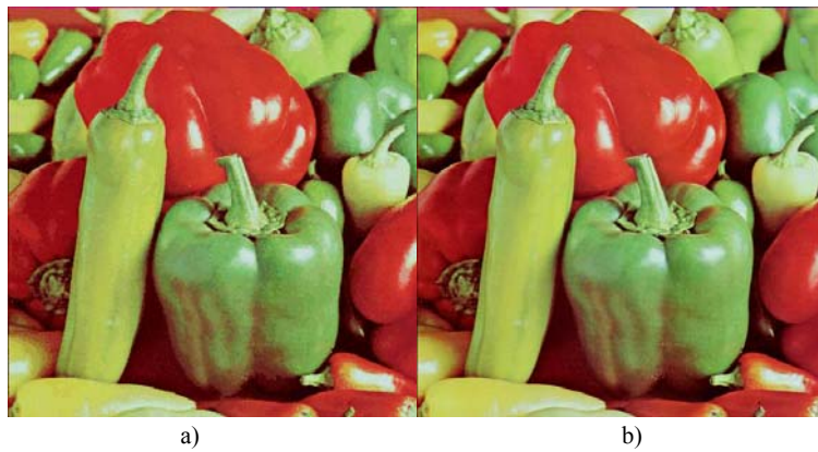
Fig. 7. a) Imagen peppers.bmp comprimida con un codebook de 256 elementos y codewords de 2x2 pixeles. (PSNR: 29,8179) b) Imagen peppers.bmp sin tratar
