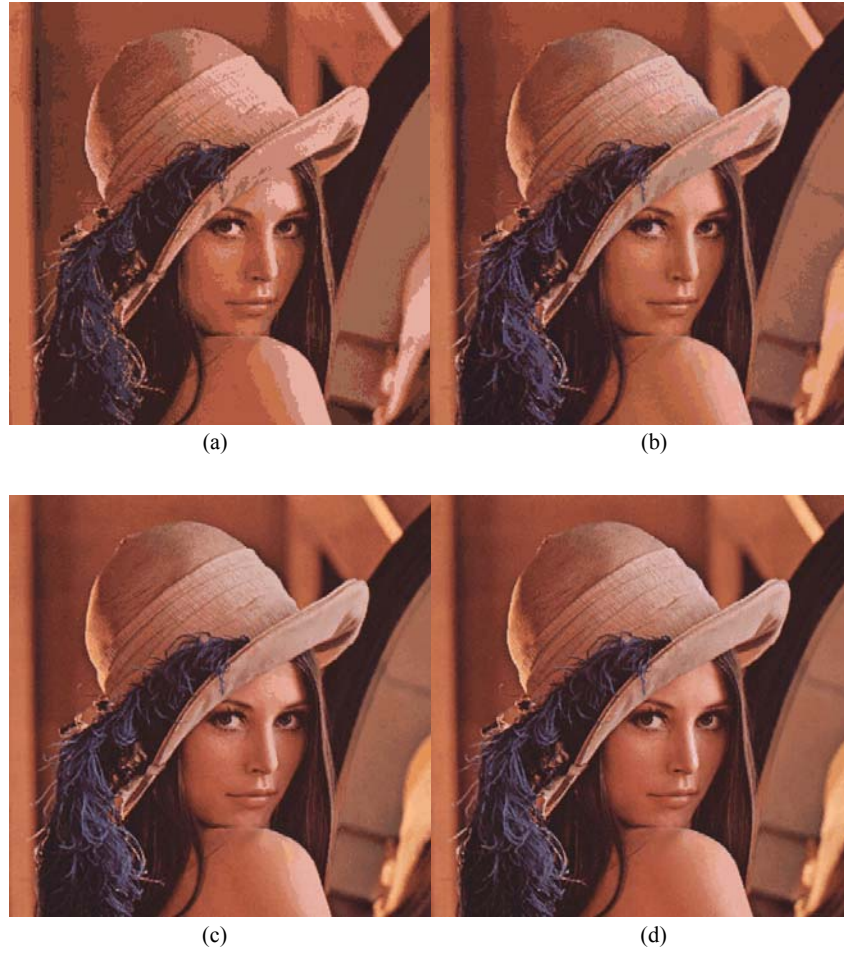
Fig. 5. Aplicación del tamaño de codeword óptimo (2x2 píxeles) a la imagen lena.bmp para codebooks de a)16, b)21, c)256 y d)512 codewords
