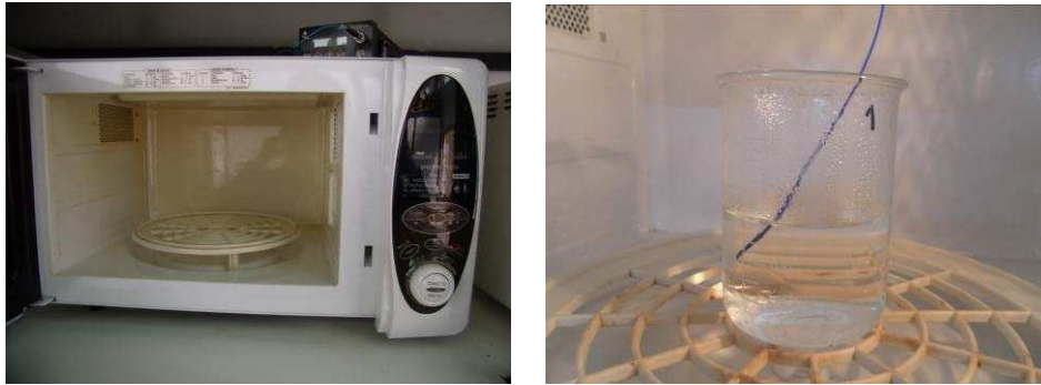
Figura 2. Medición de la temperatura con sonda de fibra óptica dentro del vaso con agua destilada durante el calentamiento en horno de microondas.
