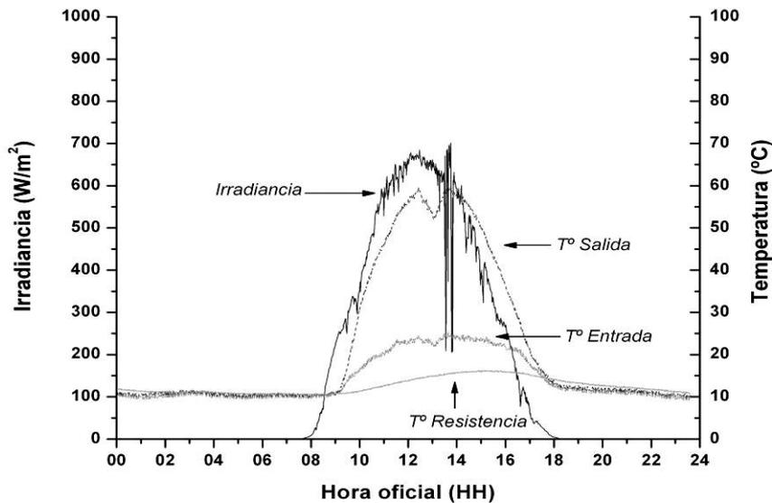
Figura 4. Curvas de los distintos parámetros medidos con el colector heliotek. La temperatura de la resistencia representa la temperatura del agua de red
