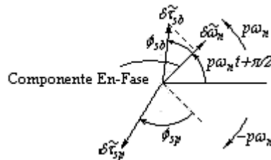
Fig. 4 – Fasores de Torque de Perturbación Referidos al Sistema Eléctrico
