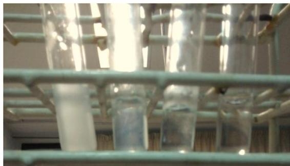
**Figura 2-1** Reacción de precipitación de AgX con (de izquierda a derecha): agua corriente; extracto del primer lavado; extracto del último lavado; agua ultra pura.
