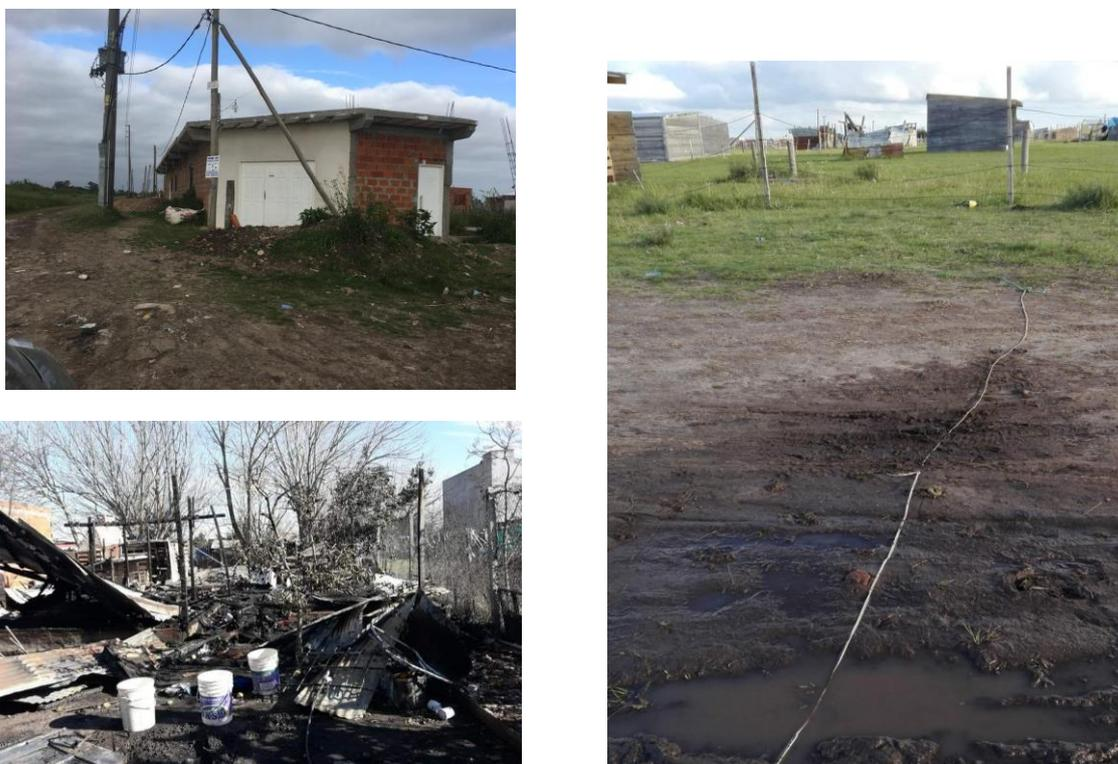
**Figura 70.** Conexiones precarias en distintos sectores del barrio y restos de una vivienda incendiada por accidente eléctrico.
