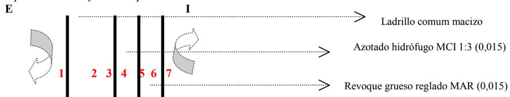
Figura 3: Ubicación de los Nodos de Temperatura dentro del muro simple de ladrillo común visto
