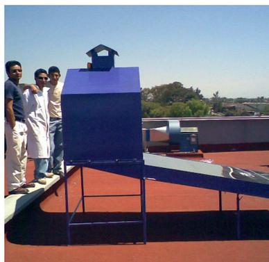
Figura 11.- Secador Solar
