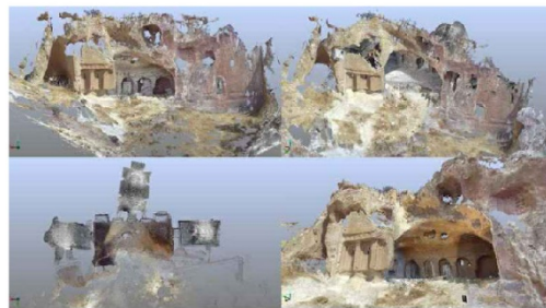
Modelo numérico con laser escaner 3D. Capadocia, Sahinefendi, Monasterio. 2014
