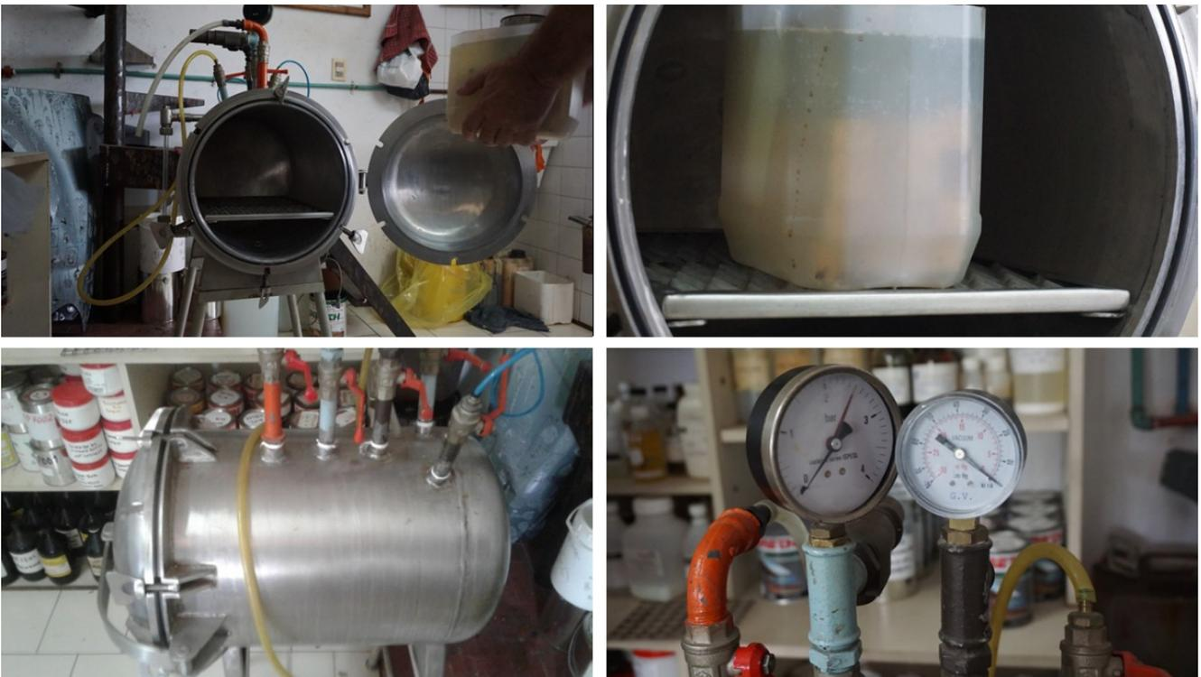
Figura 2: Arriba: Probetas de madera en contenedor, sumergidas en el preservante, dentro del autoclave. Abajo: Autoclave, vista general; manómetros que indican la presión utilizada en el proceso de impregnación.
