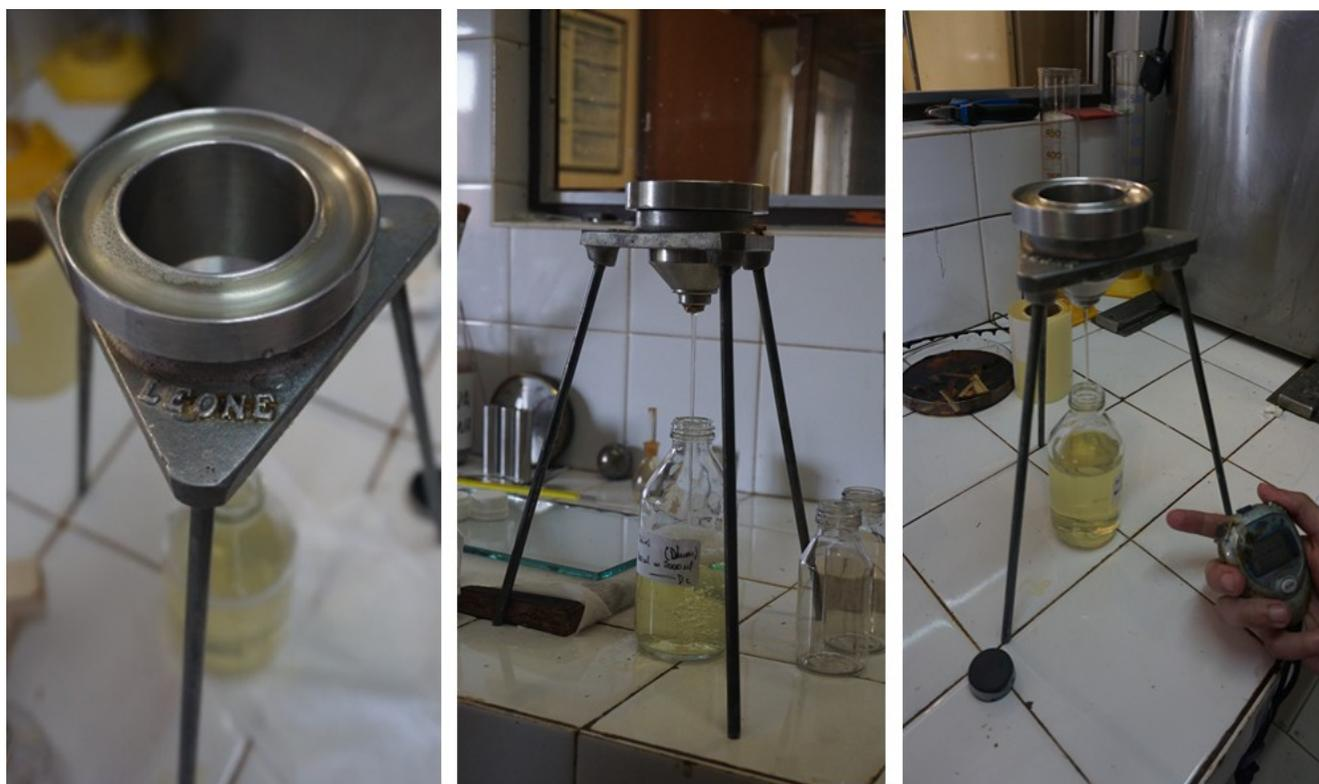
**Figura 2:** Izquierda: copa de flujo de viscosidad FORD/ASTM D1200 experimental. Medio y derecha: Formulado experimental fluyendo a través de la copa Ford. Medición del tiempo que tarda en fluir.
