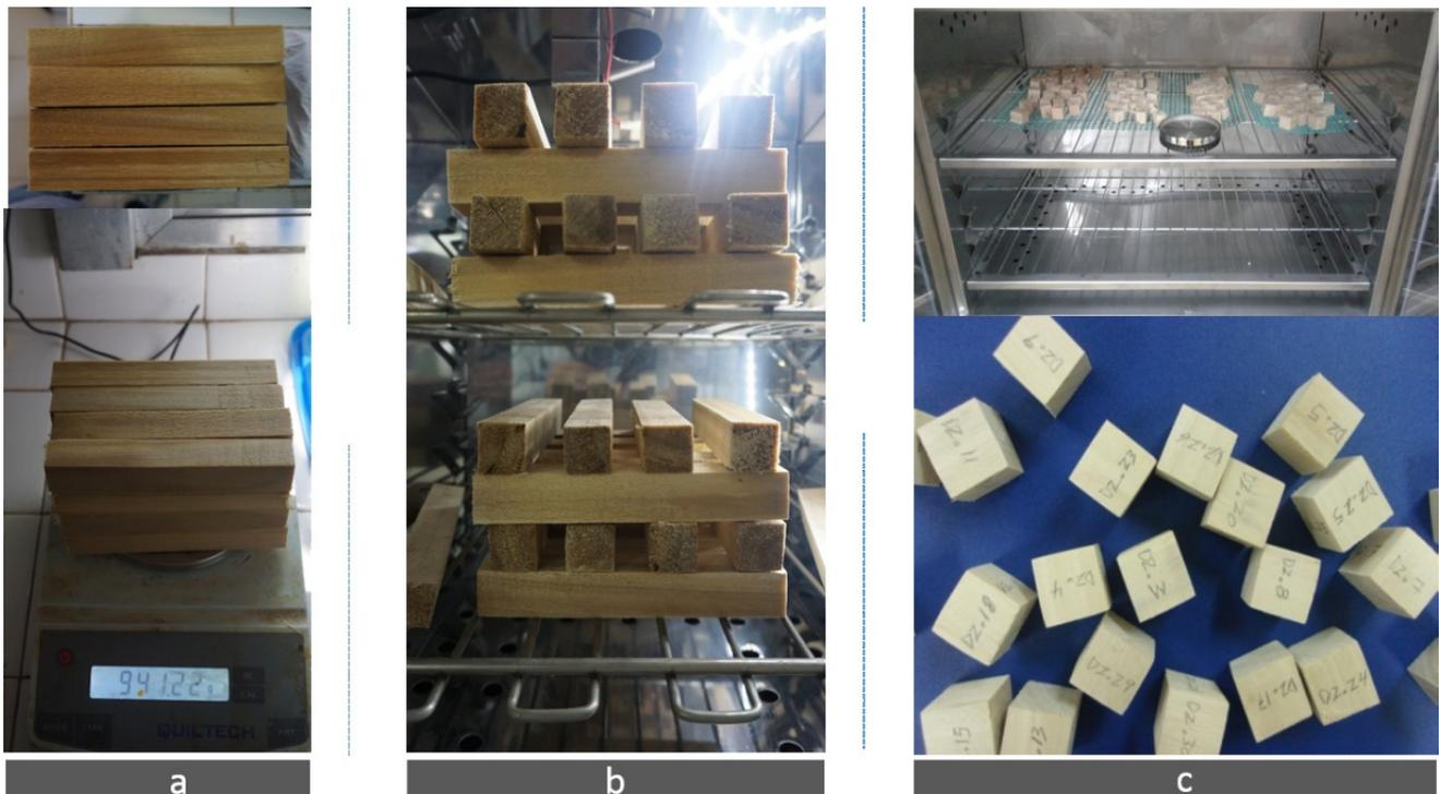
**Figura 3:** a) Pesado de la madera recién impregnada. b) Secado en estufa y c) Corte del listón grande impregnado en probetas de 20 mm de lado
