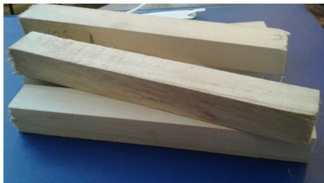
**Figura 3:** Listones de madera de *Populus x canadensis* I-214 de 20mm x 20mm x 160mm utilizados para la obtención de las probetas de los ensayos de durabilidad
