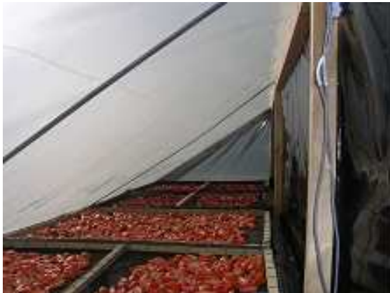
Fig. 9. Vista de las bandejas cargadas con tomates cortados en gajos en el interior del secadero.
