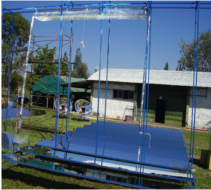
Figura 1: Vista de frente del área de 42 m 2 de espejos.
