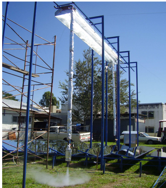
Figura 2: Vista de los espejos y absorbedor iluminado. Se aprecia la producción de vapor
