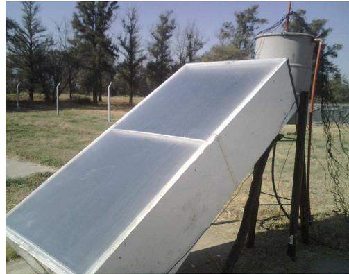
Fig. 2. Vista del calentador solar de agua
